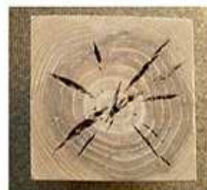
人工乾燥 内部割れ
