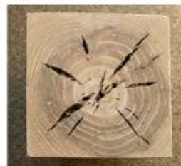
人工乾燥 内部割れ
